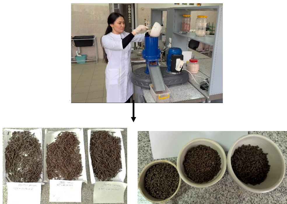
Рисунок 3.7.3 – Формование гранулированных образцов экструзией
