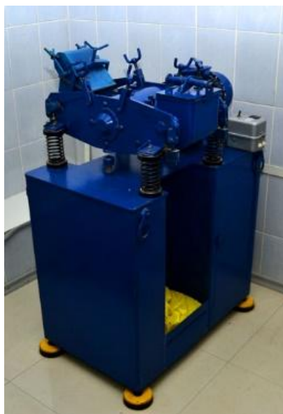
Рисунок 2.3.1 - Шаровая мельница на базе стенда вибрационного универсального СВУ-2
