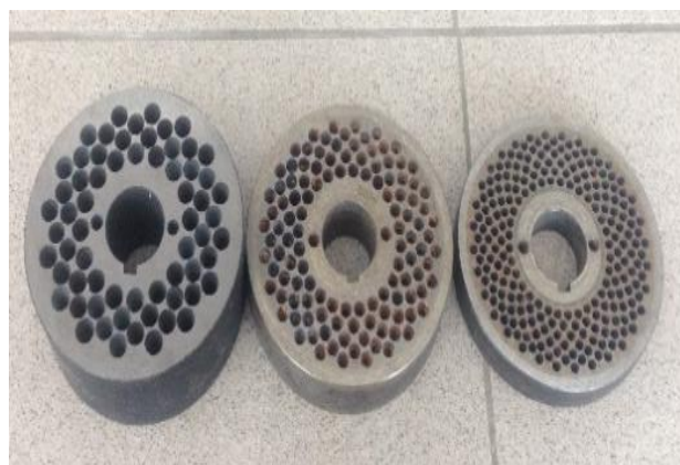
Рисунок 2.4.3 - Гранулятор ГМ-100 с матрицами для экструзии гранул
