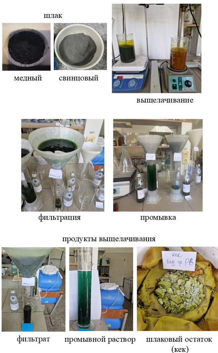
Рисунок 3.2.4 - Порядок проведения процесса солянокислотного выщелачивания
