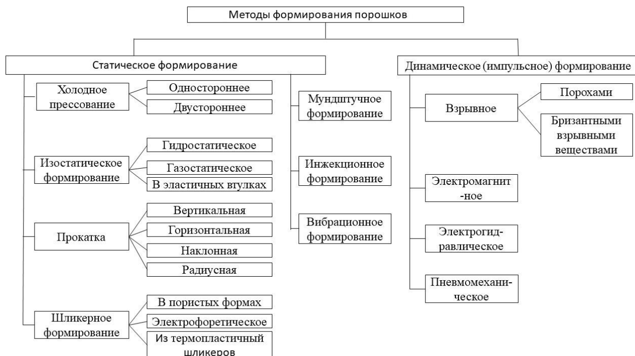
Рисунок 1.3.1 – Схема методов формования порошков
