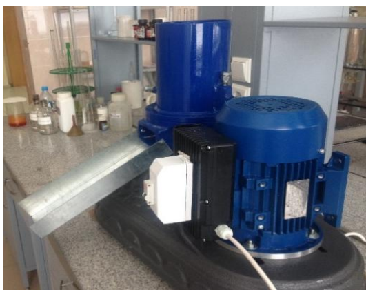
Рисунок 2.4.3 - Гранулятор ГМ-100 с матрицами для экструзии гранул
