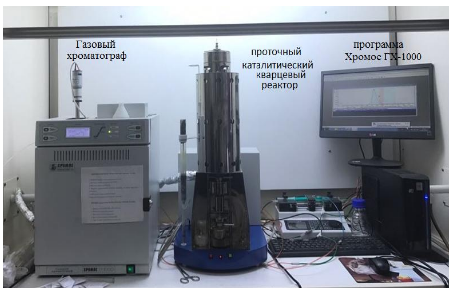
Рисунок 3.6.4 - Проточная каталитическая установка (ПКУ-1)
