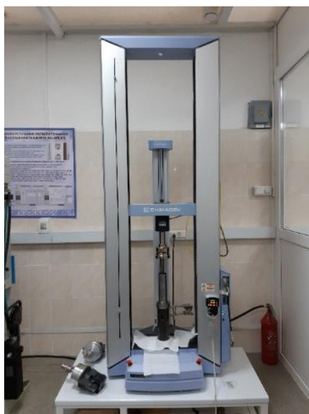
Рисунок 2.4.4 – Универсальная машина Shimadzu Autograph AG-Xplus
